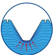
**Der Vorteil der Stalgast-Technologie:** Das spanlose Einpressen des Gewindes verhindert, dass die Innenstruktur des Materials beschädigt wird.
