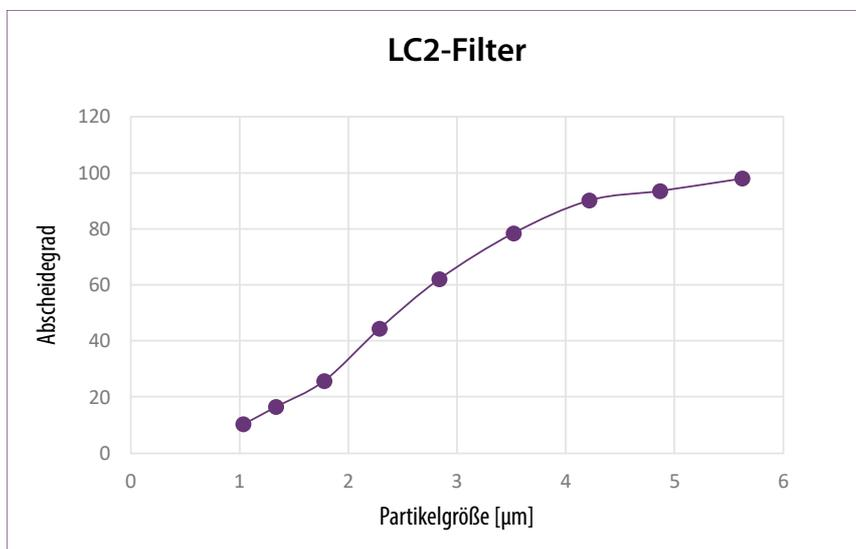
Abscheidegrad des LC2-Filters bei einem Luftdurchlass von 700m<sup>3</sup>/h
