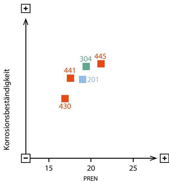
Typische Werte des Lochfraßkorrosionspotentials bei NaCl 0.02M, 23°C, pH 6,6 durch Berechnung der PREN (Wirksumme), berechnet nach der Formel  $\%Cr+3.3\%Mo+16\%N$ .
